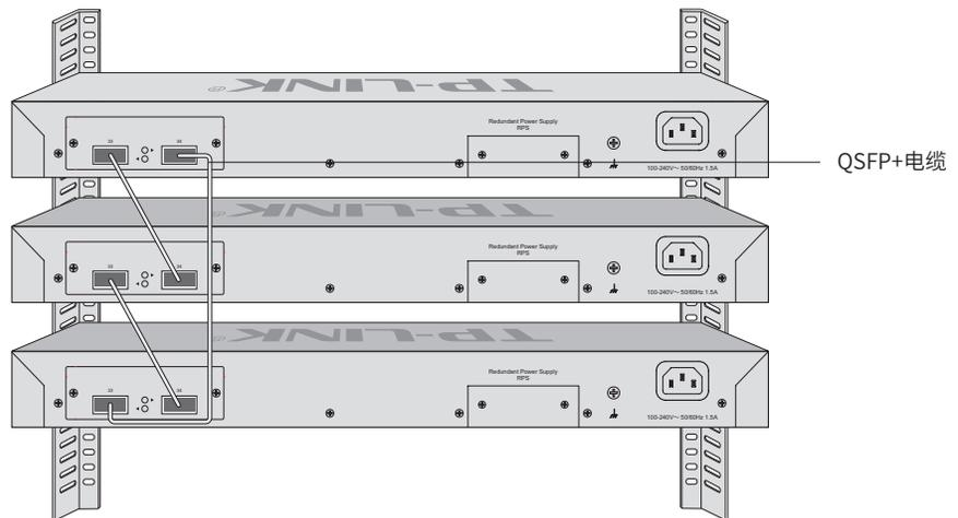
图2-5 使用QSFP+端口建立堆叠示意图
